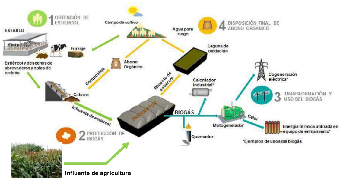
Figura 3 - Esquema de ciclo cerrado del carbono en un sistema de producción de biogás con biomasa de agricultura y residuos animales (Caso de estudio 3).
