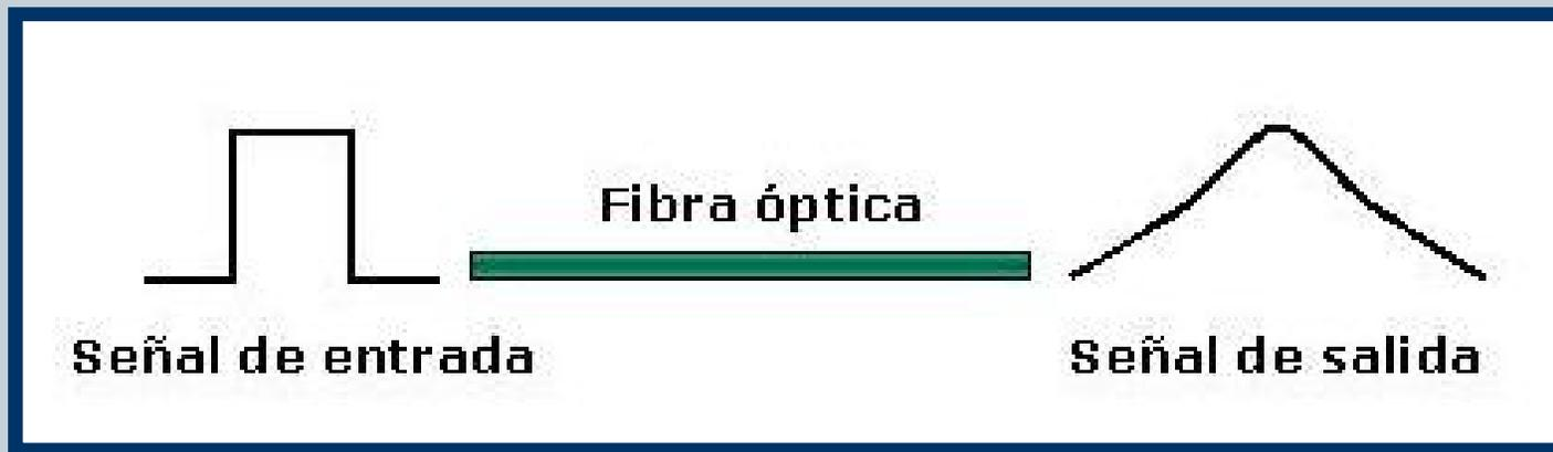
Definición: Otro factor que afecta las transmisiones ópticas es la dispersión. La dispersión reduce el ancho de banda efectivo para la transmisión por el ensanchamiento de los pulsos.
